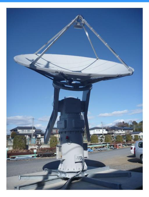
放送衛星をはじめ、準天頂衛星、低軌道周回衛星追尾などに使用する、  $4.5 \text{m} \phi \times 3.0 \text{m} \phi \times 2.0 \text{m} \phi$ アンテナを搭載した衛星追尾用回転装置の 設計、製作、施工を行っております。
